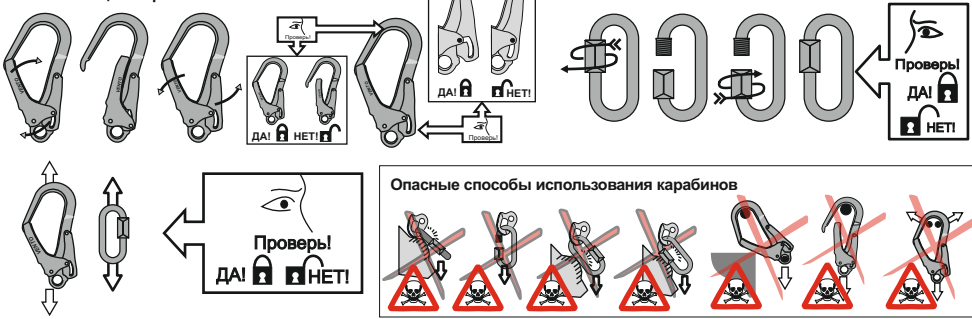
Рис. 7. Способы крепления стропов к анкерным устройствам
