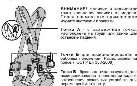
Рис. 4. Расположение и назначение крепежных точек на привязях
