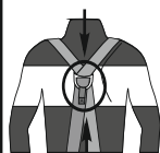
Рис. 7. Правильное положение страховочной точки А на спине
