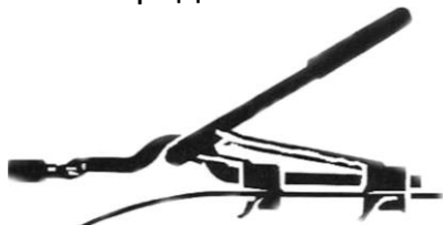
Рис. 4 Типовая лебедка для натяжения троса
