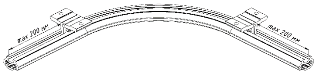
Рисунок - 5 Монтаж углового сегмента.
