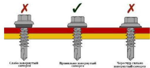
Рис. 5 Схема монтажа саморезов
