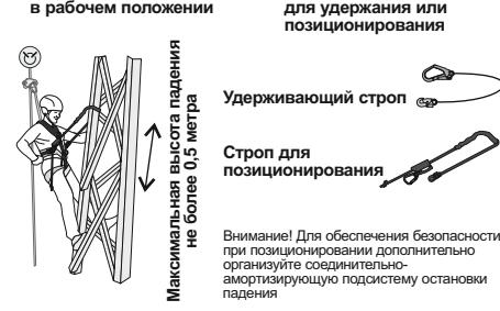
Внимание! Для обеспечения безопасности при позиционировании дополнительно организуйте соединительно-амортизирующую подсистему остановки падения
