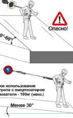
Обязательное использование стального стропа с амортизатором
