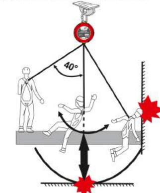
Рис. 9. Использование на горизонтальных и наклонных поверхностях
