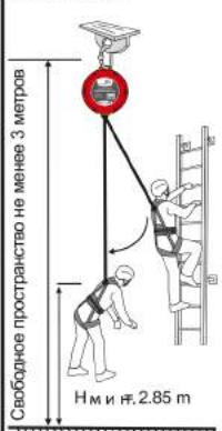
Рис. 11. Проверка перед использованием
