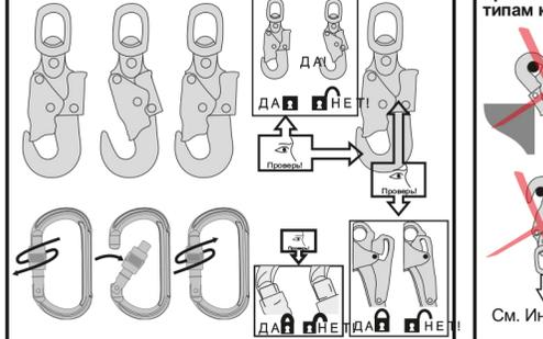
**Рис. 6. Ограничения по способу приложения нагрузки относятся ко всем типам карабинов**
