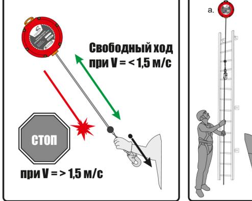
**Рис. 12. Вытягивание и втягивание троса**
