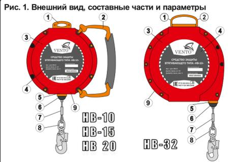
1. Силовой элемент для крепления к анкерному устройству
