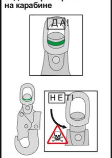
**Рис. 8. Ограничения по использованию средств защиты втягивающего типа НВ**
