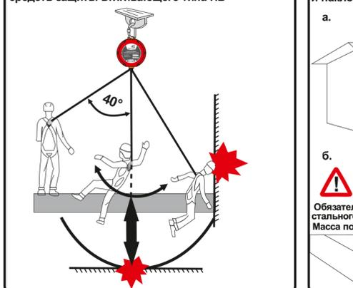
**Рис. 9. Использование на горизонтальных и наклонных поверхностях**
