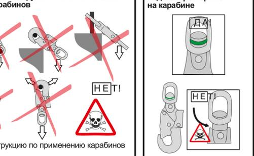
**Рис. 7. Проверка индикатора срыва на карабине**
