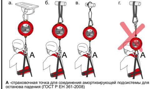
**Рис. 4. Соединение НВ с привязью**
