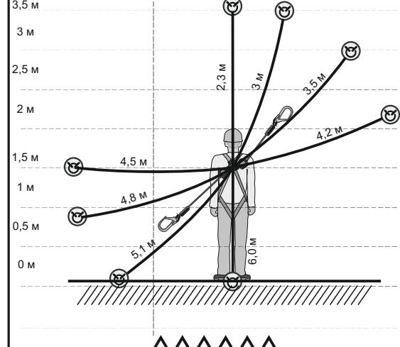
Расчет приведен для полностью вытянутого страховочного стропа
