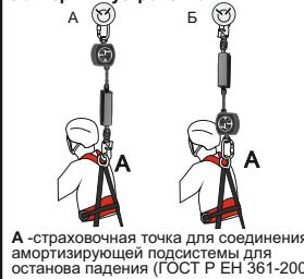
Рис. 4. Допустимые варианты соединения «НВ-02 трос» с привязью
