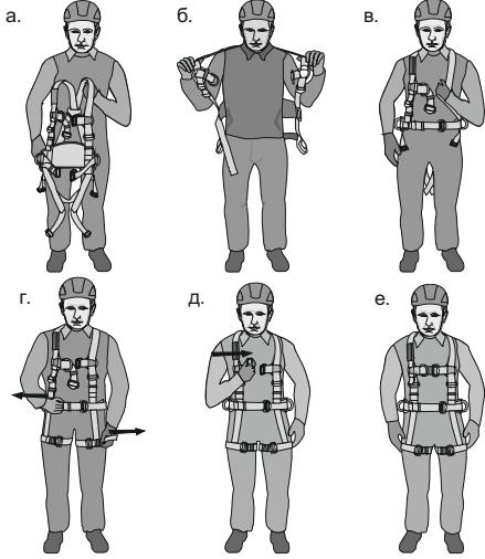
Рис. 6. Типы используемых пряжек, способы заправки
