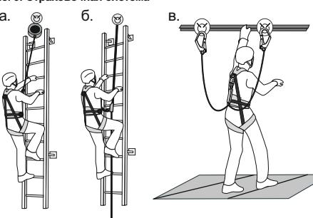
Рис. 10. Соединительно-амортизирующая подсистема
