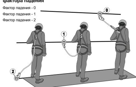
Рис. 5. Способы надевания привязи
