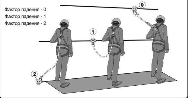
Рис. 4. Расположение и назначение крепежных точек на привязях
