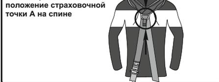
Рис. 9. Правильное крепление соединительного карабина
