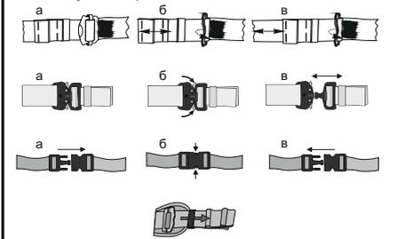
Рис. 6. Надевание привязи «Энерго»
