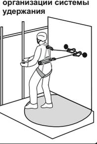
Рис. 14. Позиционирование в рабочем положении
