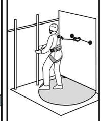
Рис. 13. Позиционирование в рабочем положении
