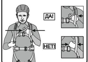
Рис. 2. Типы крепежных точек
