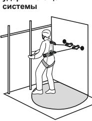
Рис. 13. Позиционирование в рабочем положении
