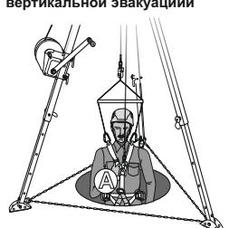
Рис. 15. Пример организации системы канатного доступа
