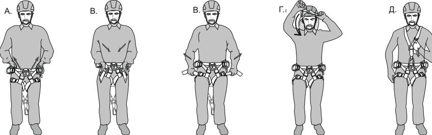
Рис. 7. Правильное крепление соединительного карабина
