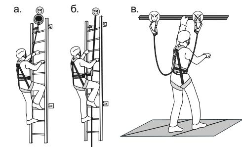
Рис. 11. Соединительно-амортизирующая подсистема
